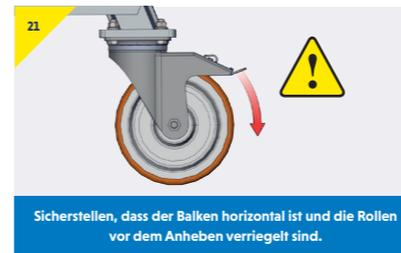
Sicherstellen, dass der Balken horizontal ist und die Rollen vor dem Anheben verriegelt sind.
