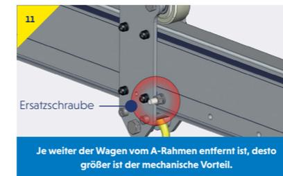
Je weiter der Wagen vom A-Rahmen entfernt ist, desto größer ist der mechanische Vorteil.
