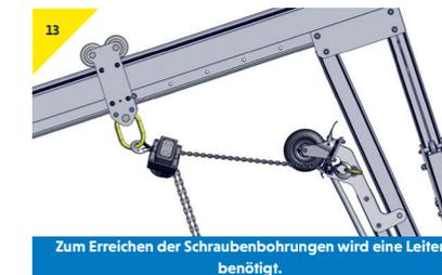
Zum Erreichen der Schraubenbohrungen wird eine Leiter benötigt.
