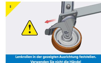
**Lenkrollen in der gezeigten Ausrichtung feststellen. Verwenden Sie nicht die Hände!**
