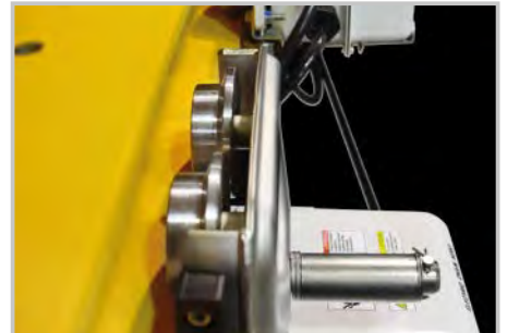
Laufräder beider Fahrwerke aus Edelstahl
