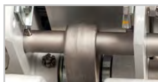
Vernickelter Aufhängungsbolzen und Verbinder
