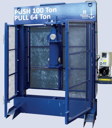
Mit unserer Prüfmaschine führen wir dokumentierte Zugprüfungen bis 64 t und Druckprüfungen bis 100 t durch!
