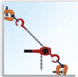
Diese IPSC10-Klemme kann zum Positionieren von Stahlblechen und -sektionen verwendet werden.
