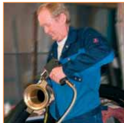
Schlauchmontage mittels Klemmschale
