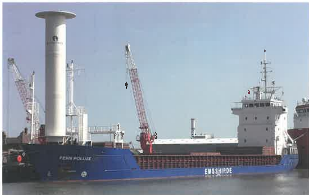
Mit Rotorsegel im britischen Great Yarmouth: die 90 Meter lange und 13 Meter breite „Fehn Pollux“
